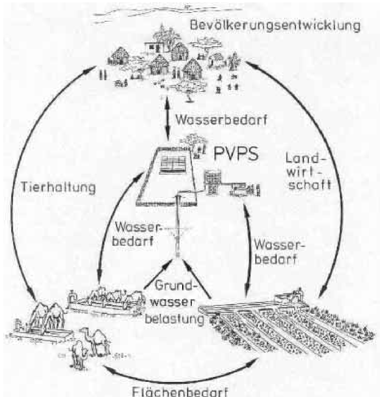
Abb. 48: Übergeordnete Vernetzung und Beeinflussungen bei photovoltaischen Pumpensystemen
