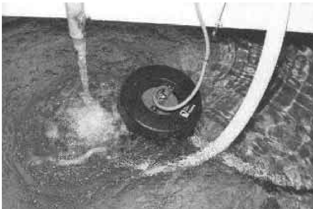
Abb. 23: Schwimmpumpe mit bürstenlosem Gleichstrommotor
